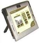
Consola móvel para controlo da tecnologia de áudio / vídeo, tecnologia de segurança e automação residencial. O estado dos edifícios e dispositivos KNX podem ser visualizadas e activados. O sistema operacional é o Windows XP. A comunicação é efectuada através do adaptador de LAN sem fio integrado. Cobertura dos edifícios é de 30 m. Tempo de execução de bateria é de cerca de 3-4 horas. Docking station e alimentação estão incluídas.
